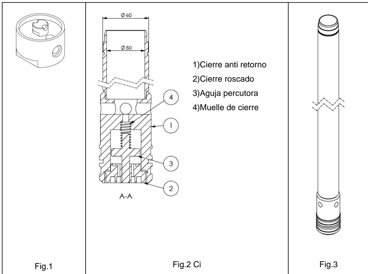
La fig.2 muestra una sección del cierre anti retorno del pistón, que está soldado en la parte inferior del vástago intermedio, dando como resultado el subconjunto mostrado en la fig. 3
